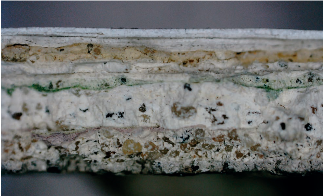
3. Przekrój poprzeczny nawarstwień na ścianie południowej, 2020. Fot. mikroskopowa Katarzyna Feć-Sfora
