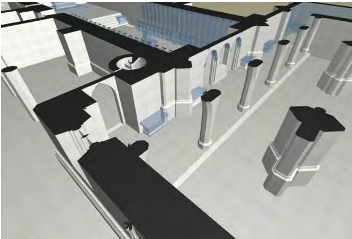
5. Cyfrowy model rekonstrukcyjny kościoła Świętej Trójcy, strefa lektorium, widok aksonometryczny. Modelowanie Jacek Czechowicz wg chmury punktów (pomiar ArchiTube)
