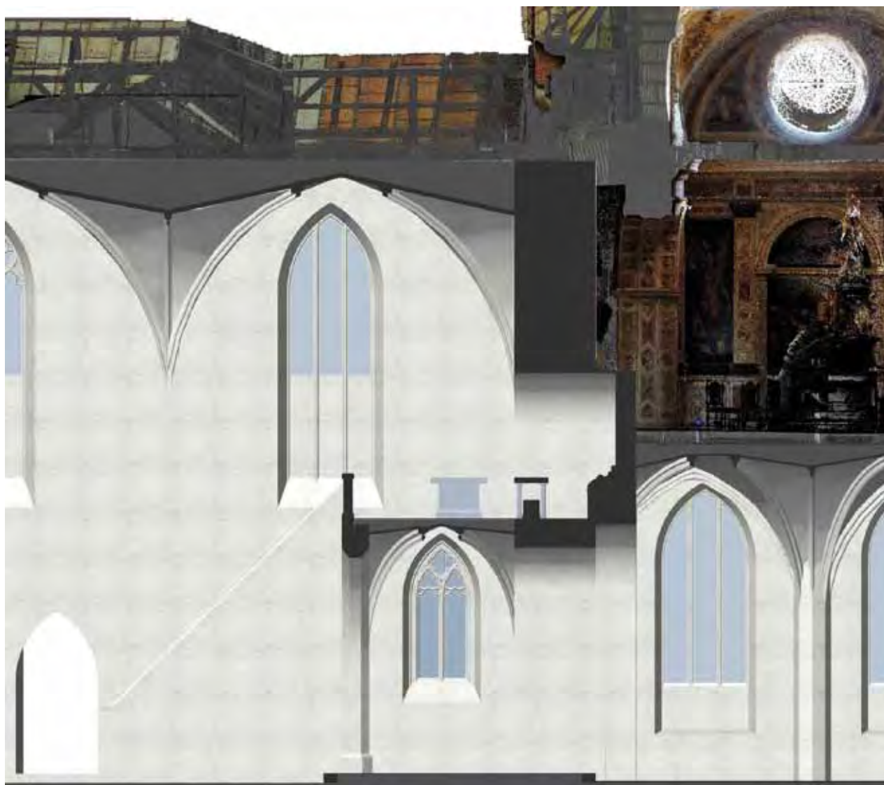
10. Cyfrowy model rekonstrukcyjny kościoła Świętej Trójcy, stan po budowie I kaplicy św. Jacka (1543). Zestawienie przekroju podłużnego lektorium i kaplicy z obecną kaplicą św. Jacka. Modelowanie Jacek Czechowicz wg chmury punktów (pomiar ArchiTube)
