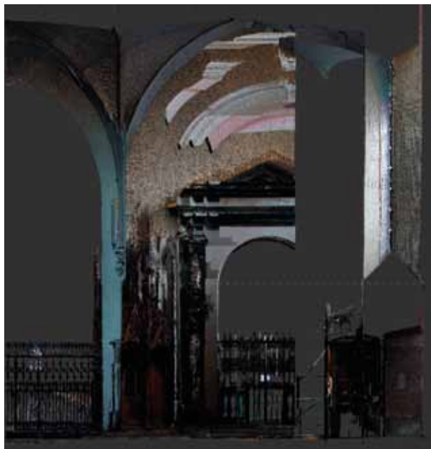
21. Kraków, kościół Dominikanów, porównanie wysokości odsadzki na relikwie przypory w zachodniej ścianie kaplicy św. Tomasza i odsadzki w fasadzie. Pomiar ArchiTube, oprac. Jacek Czechowicz
